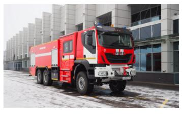
(КБР). Кабина водителя и расчета образовывают общий салон и представляют собой единую пространственную герметичную конструкцию, обеспечивающую возможность оперативной посадки и высадки, удобство и безопасность размещения боевого расчета.
